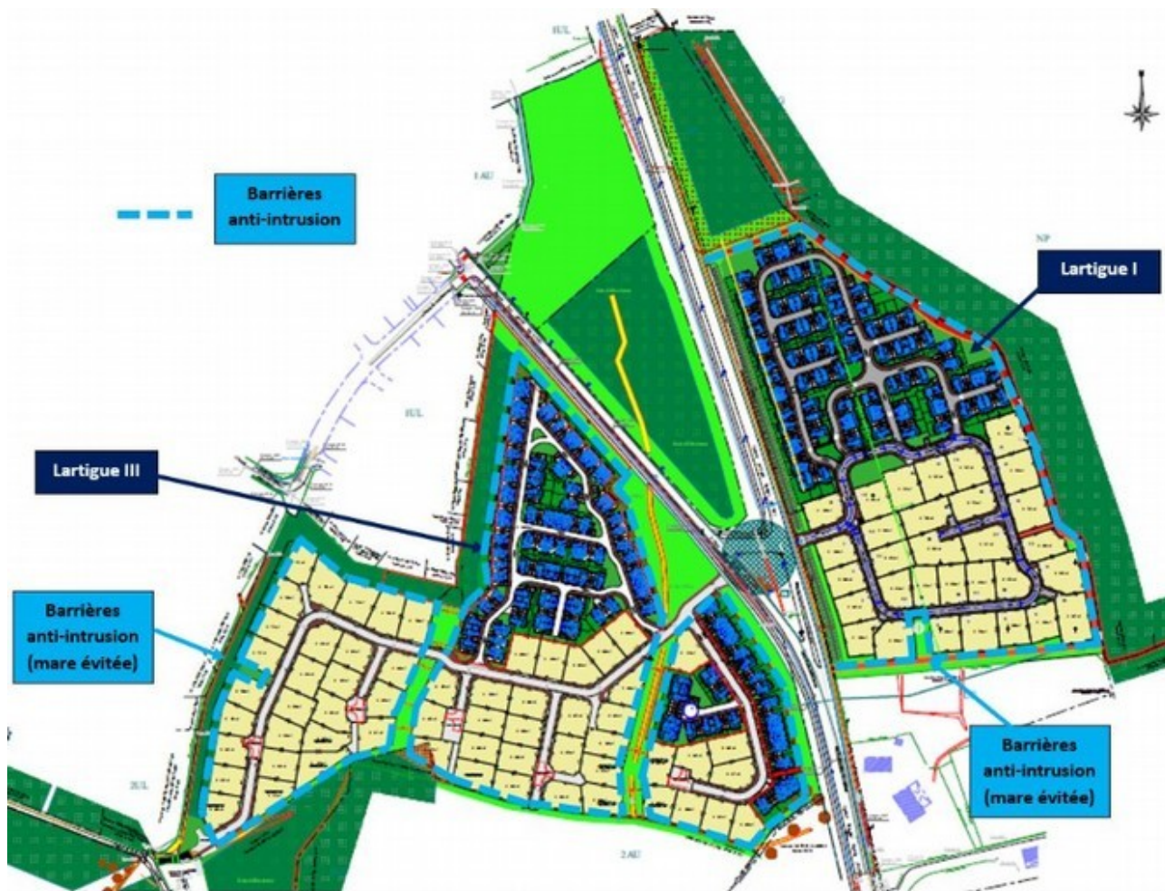
Figure 2 : Localisation des barrières anti-intrusion
